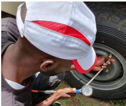
Le poids de la voiture repose uniquement sur la partie du pneu en contact avec le sol et entraîne une déformation.
